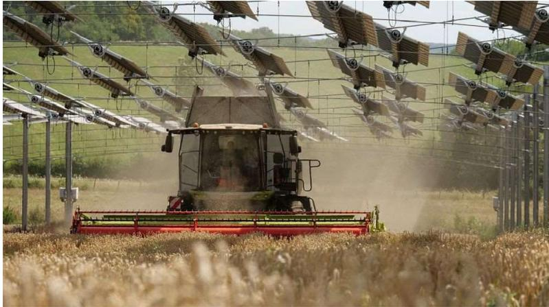
**FIGURE 10 : PHOTOGRAPHIE - MOISSONNEUSE A L'ŒUVRE SOUS PANNEAUX SOLAIRES MOBILES - PAR ALLIANCE BFC**
